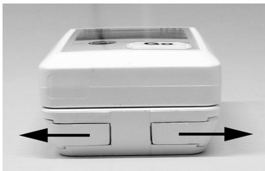
1. Выдвините в разные стороны оба фиксатора нижней части настенного кронштейна.
