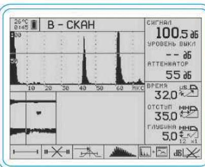
Позволяет быстро устанавливать дефектные зоны и определять их координаты.
