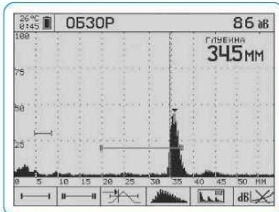
Удобен для толщинометрии и дефектоскопии с использованием прямого преобразователя.
