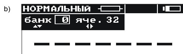
Рис.3. Вид экрана после включения измерителя (объект активного сопротивления, автоматическое введение в память). Способ отображения: а) все результаты; б) только главный результат
