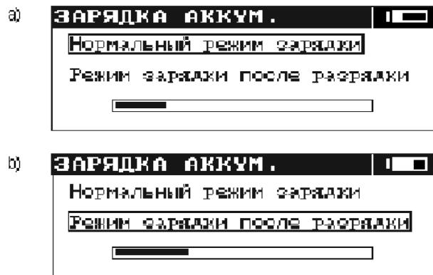
Рис. 15. Режим зарядки аккумуляторов – выбор режима
