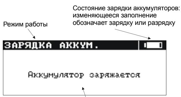
Рис. 16. Режим зарядки аккумуляторов – зарядка
