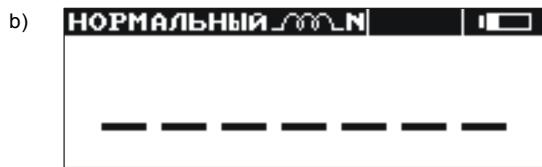
Рис.2. Вид экрана после включения измерителя (тип индуктивного объекта с нормальным временем измерения, ручное введение в память). Способ отображения: а) все результаты; б) только главный результат
