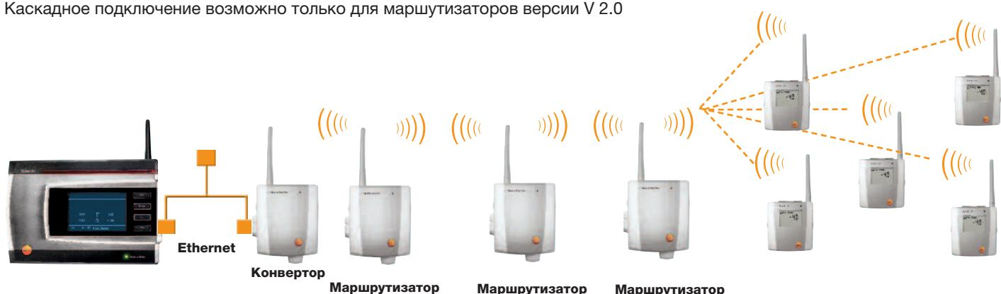
**Расширение радиуса передачи данных с использованием конвертора и топологии “звезда”**
