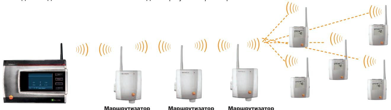
**Возможность каскадного подключения маршрутизаторов и конвертора**
