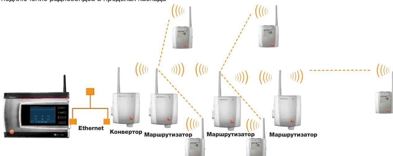
**testo Saveris™****Обзор системы мониторинга данных измерений****База testo Saveris**
