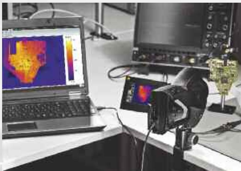
Любой фрагмент записи содержит данные температуры по каждому пикслю, что позволяет с точностью проанализировать все стадии процесса нагрева в течение определенного промежутка времени. Кроме того, функция регистрации данных обеспечивает возможность создания серии отдельных изображений в заданные временные интервалы или после определенных событий, например, превышения допустимых предельных значений.
