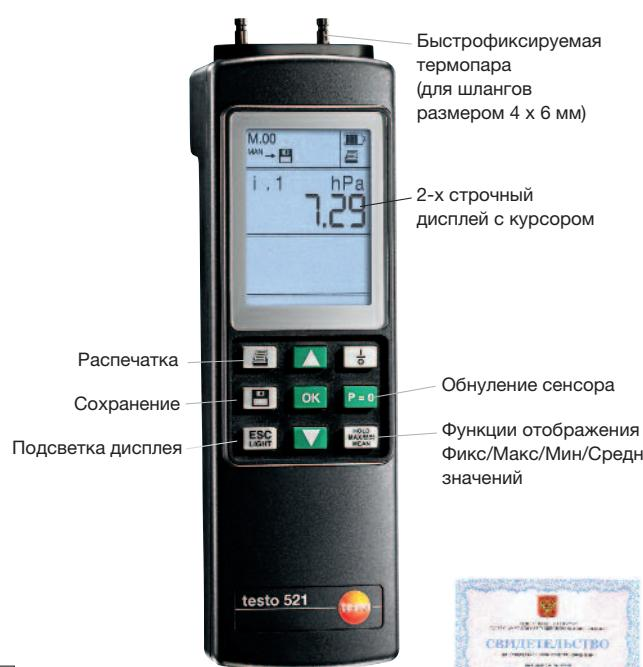
**2** testo 521-2, дифференц. манометр от 0 до 100 гПа (погрешность 0,1% от полной шкалы), вкл. батарейку и заводской протокол калибровки
