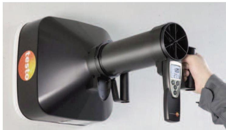
Запатентованный выпрямитель потока testovent 417 изменяет характеристики потока на вихревых диффузорах и дает возможность преобразовать турбулентный поток в практически равномерный. Таким образом, снижается влияние вихря на вращение крыльчатки, что позволяет быстро и легко и измерить объемный расход с высокой точностью, например, с помощью анемометра с крыльчаткой testo 417.
