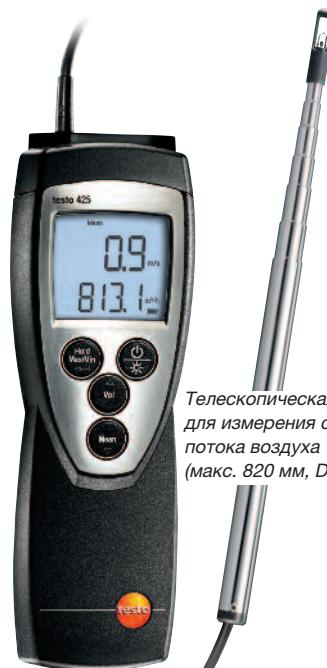
Телескопическая рукоятка для измерения скорости потока воздуха (макс. 820 мм, D 7.5 мм)
