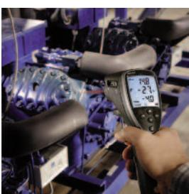
...для определения температуры поверхностей двигателей, корпусов и несущих компонентов больших и малых моторов.
