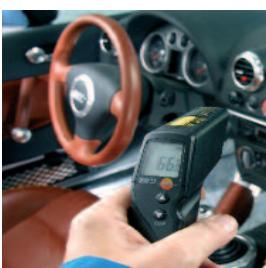
...на объектах слабой теплопроводности, таких как керамика, резина, пластик и т.д. Сенсор прибора для контактного измерения способен отображать корректные показания температуры, если он принимает температуру объекта измерения. В случае с измерением объектов слабой теплопроводимости время реакции очень большое.
