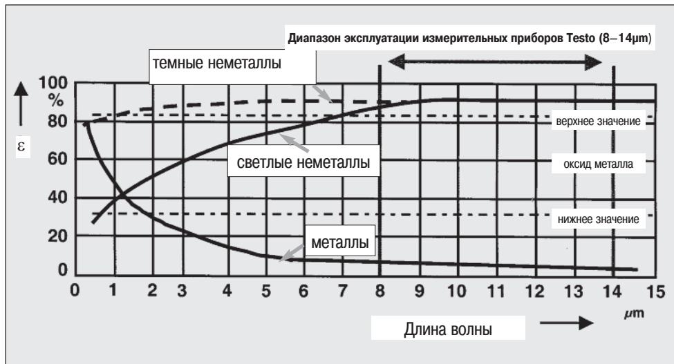
Коэффициент излучения разных материалов зависит от длины волны (схематическое представление)
