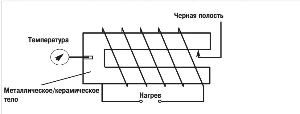
считываются помехами измерения. Соответственно, реальное тело может быть представлено схематически следующим образом:
