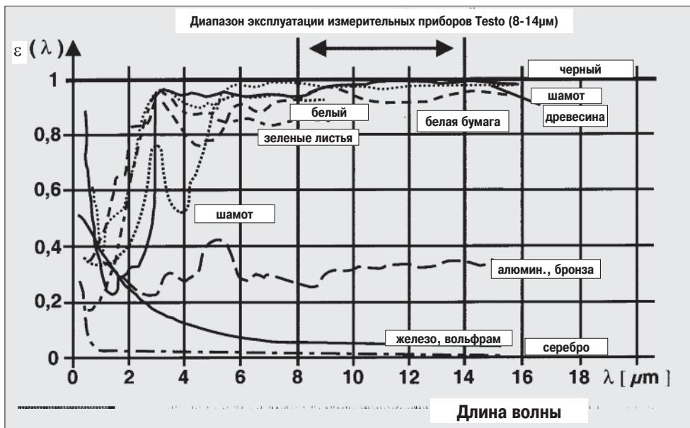
Коэффициент излучения разных водонепроницаемых материалов зависит от длины волны
