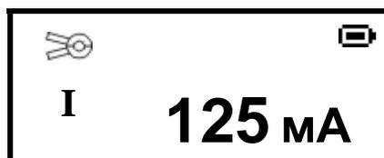
Рисунок 2.3.7 - Вид индикатора при измерении переменного тока с применением клещей
