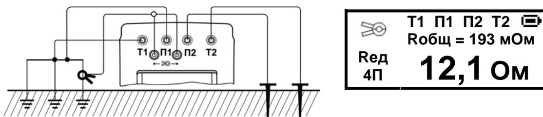
Рисунок 2.3.9 - Схема подключения и вид индикатора при измерении сопротивления единичного заземлителя
