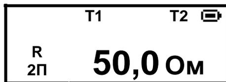
Рисунок 2.3.3.2 - Вид индикатора при двухпроводном методе измерения
