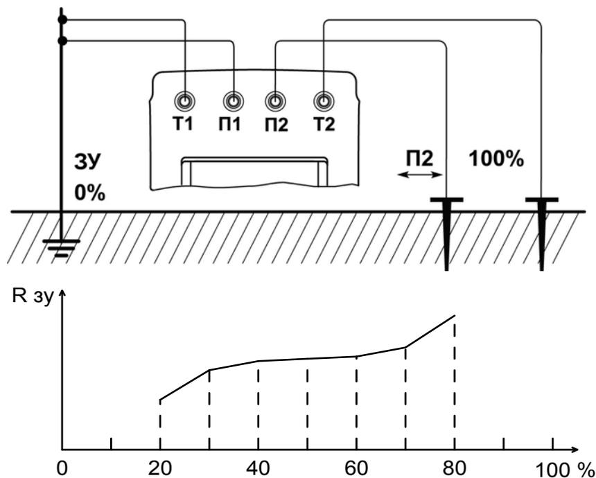
Рисунок 2.3.4 Схема измерения сопротивления заземления четырёхпроводным методом
