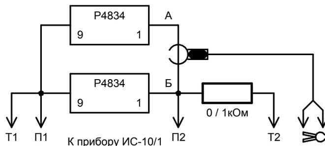
Рисунок 6.6.4 - Схема подключения при определении сопротивления единичного заземлителя
