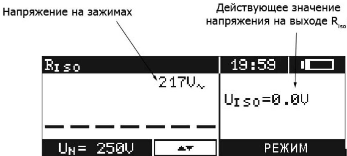
Рис.26. Организация экрана при измерении сопротивления изоляции
