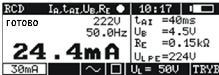
Рис.18. Вид экрана при измерении тока отключения УЗО
