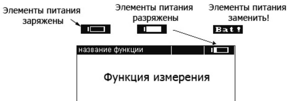
Рис. 51. Мониторинг состояния зарядки элементов питания или аккумуляторов
