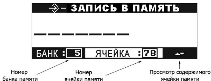
Рис.3. Вид экрана при записи в память
