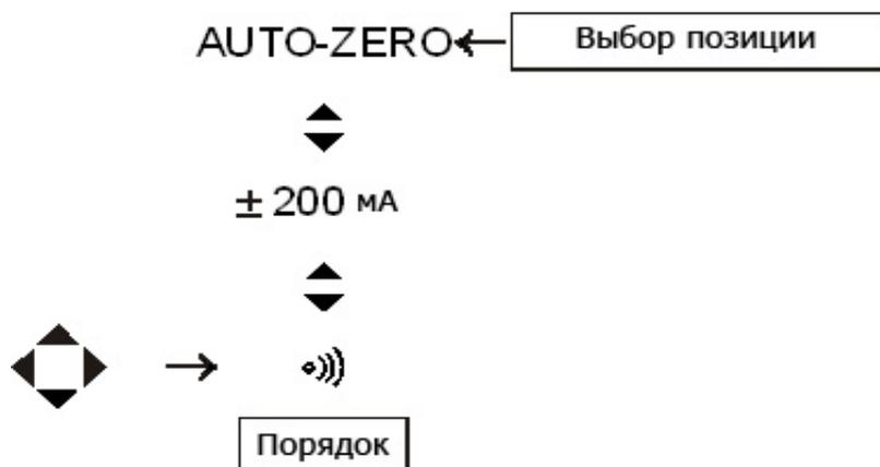
Рис.37. Установка режима компенсации сопротивления измерительных проводов
