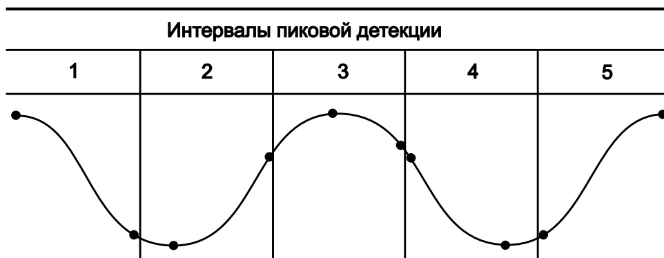
Рис. 8-19. Принцип формирования выборок пикового детектора
