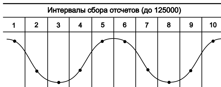
Рис. 8-18 Принцип формирования стандартных выборок
