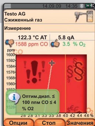
Концентрация CO в диапазоне неполного сгорания. Прибор отображает сведения по оптимальному диапазону.
