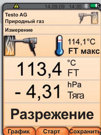
Результат измерения: наблюдается отрицательное давление (-4.31 гПа)
