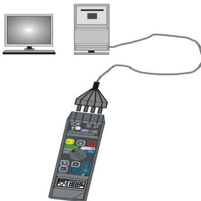
Рис.9. Соединение интерфейса с измерителем.
